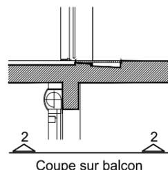
Différence de hauteur plancher/balcon Environ 20 cm
